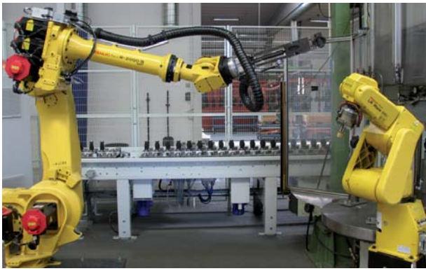
Roboter für die Handhabung von Ventilen für die Trinkwasserversorgung.
